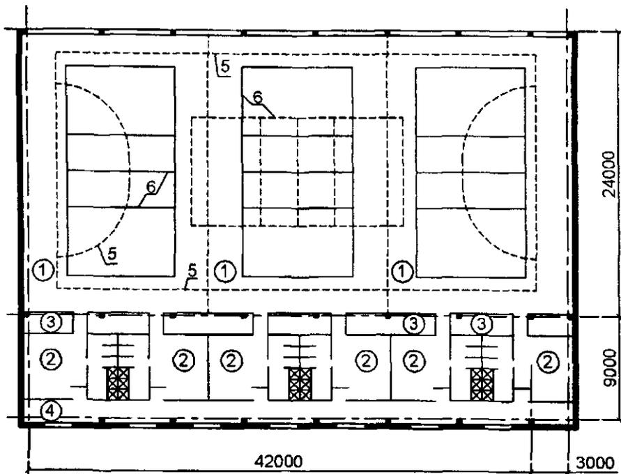
1 — секция зала (24×15 м, ЕПС = 40 чел. в смену); 2 — блок раздевальной с душевой, умывальной и санузлом; 3 — инвентарная; 4 — коридор; 5 — разметка площадки для гандбола; 6 — разметка площадки для волейбола
