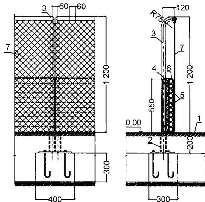
1 — пол, 2 — стакан, 3 — труба  $d = 42,3$  мм, 4 — щит из шпунтованных досок толщ 32 мм, длиной 1000 мм, 5 — шланг резиновый  $\varnothing 50$  мм, 6 — листовая резина  $5 \times 700$  мм, 7 — стальная плетеная сетка
