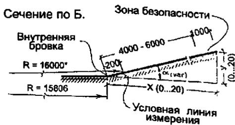
Б. ПОВОРОТ КРУГОВОЙ БЕГОВОЙ ДОРОЖКИ РАСЧЕТНОЙ ДЛИНОЙ 200 м, СОПРЯЖЕННЫЙ ПРИ ПОМОЩИ ПЕРЕХОДНОЙ КРИВОЙ С ПРЯМЫМИ ОТРЕЗКАМИ
