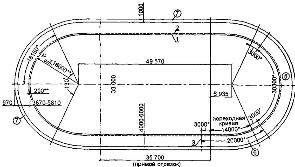
1 — внутренняя бровка дорожки; 2 — условная линия измерения расчетной длины дорожки; 3 — линия общего финиша (при максимальном удалении от поперечной оси круговой беговой дорожки); 4 — зона с постоянным уклоном 18°; 5 — зона с постоянным уклоном 14°30'; 6 — зона с переменным уклоном; 7 — зона безопасности
