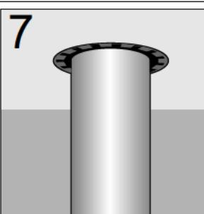
Возможен вариант крепления, когда проушины и верхняя часть корпуса муфты входят в отверстие узла пересечения конструкции и бетонируется при окончательной заливке раствором;
