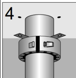
Надеть муфту на трубу совместив просверленные отверстия с проушинами, стянуть корпус замком застежкой;
