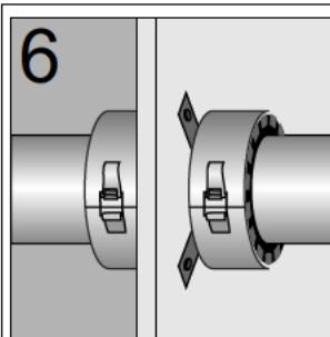
В случае с горизонтальным расположением труб, устанавливать муфты следует с двух сторон конструкции;
