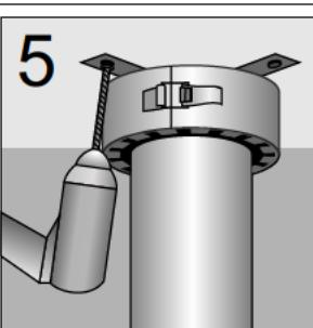
Закрепить муфту с помощью саморезов или анкерных болтов. **ВНИМАНИЕ! ДЛЯ КРЕПЛЕНИЯ МУФТ ИСПОЛЬЗОВАТЬ ТОЛЬКО МЕТАЛЛИЧЕСКИЕ ДЮБЕЛИ;**
