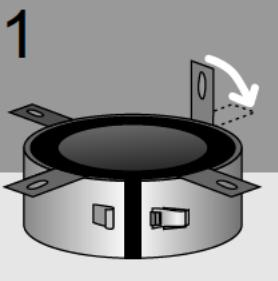
Отогнуть крепежные проушины в плоскости основания муфты;
