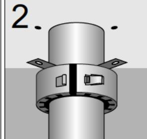
Одеть муфту на защищаемую трубу и маркером наметить места крепления проушин к ограждающей конструкции;
