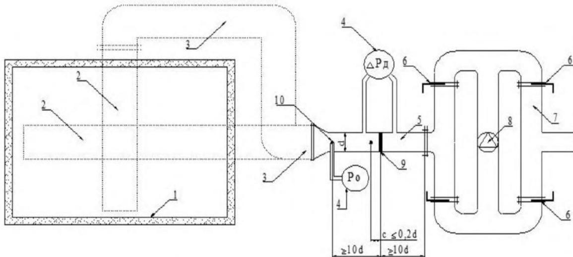
1 – печь; 2 – испытуемый образец воздуховода (установленный вертикально или горизонтально); 3 – переходной элемент; 4 – микроманометр; 5 – мерный участок; 6 – регулирующая заслонка; 7 – воздуховоды обвязки вентилятора; 8 – вентилятор; 9 – расходомерная диафрагма; 10 – точка отбора давления в полости испытуемого образца; ● – ТЭП
