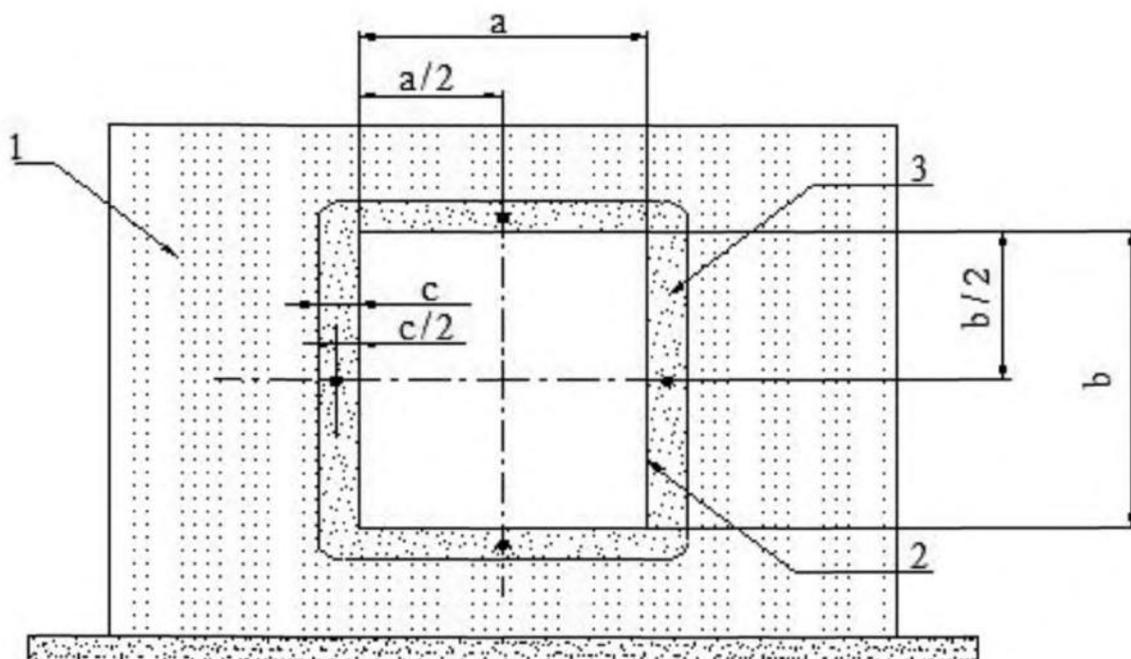
1 – печь; 2 – воздуховод; 3 – уплотнение места проходки воздуховода через ограждающую конструкцию печи;
