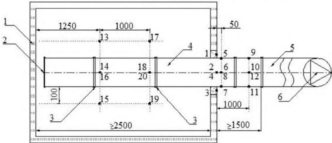
1 – печь; 2 – заглушенный торец образца; 3 – места сочленения элементов образца; 4 – испытуемый образец воздуховода (с отверстием или без него); 5 – переходной элемент; 6 – вентилятор; ● – ТЭП, установленные: 1-4 – на поверхности уплотнений воздуховода в проеме печи; 5-12 – на необогреваемых поверхностях воздуховода; 13-20 – в печи
