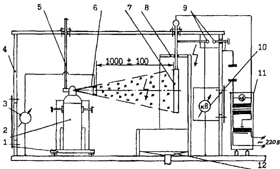
*Принципиальная схема испытательного стенда определения тока утечки по струе ОТВ:*
