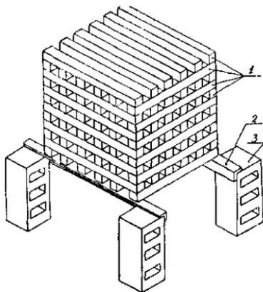
Устройство деревянного штабеля (модельного очага пожара класса А) для проведения огневых испытаний:
