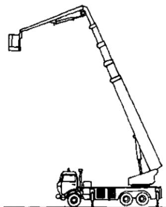
*Рисунок 1.3. Коленчато-телескопический АПК*
