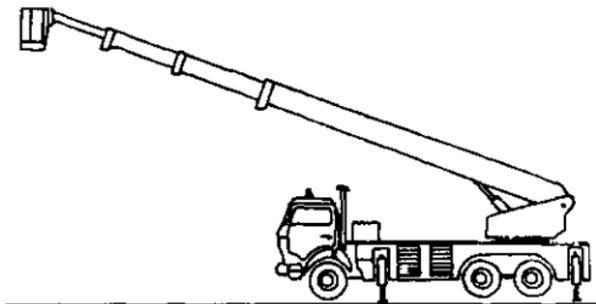
Рисунок 1.2. Телескопический АПК
