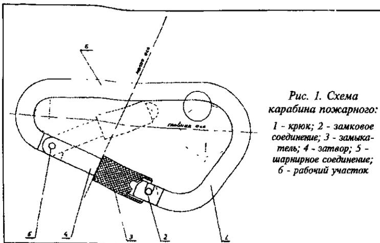
Рис. 1. Схема карабина пожарного:
