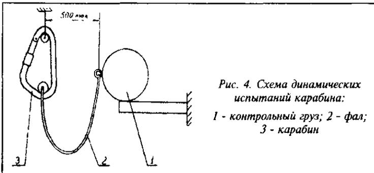
Рис. 4. Схема динамических испытаний карабина:
