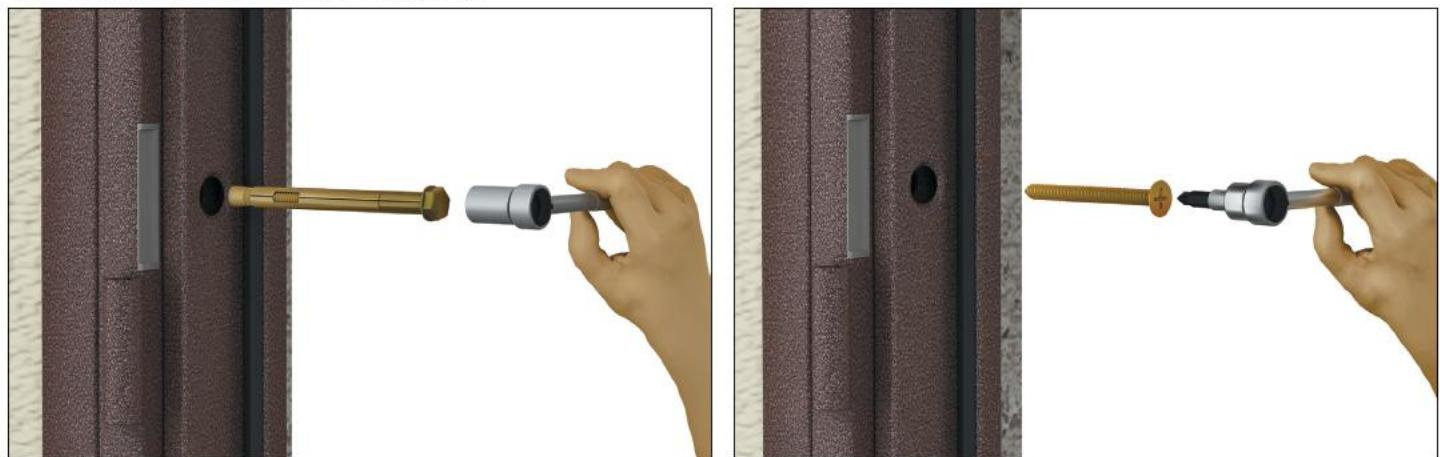
В просверленные отверстия установите анкерные болты и затяните их торцевым ключом.
