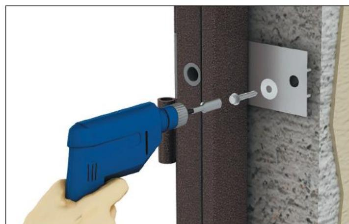
В просверленные отверстия установите дюбели и закрутите саморезы с шайбой при помощи биты.
