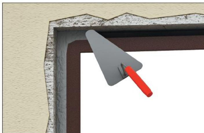
Монтажный зазор между проемом и рамой замажьте раствором цемента марки М300 и оставьте его до полного затвердевания.
