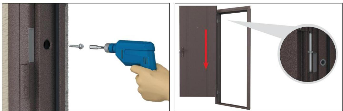
В просверленные отверстия установите дюбели и закрутите саморезы.
