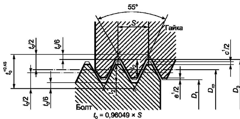
Рисунок Б.1 — Внутренняя резьба резьбового кольца
