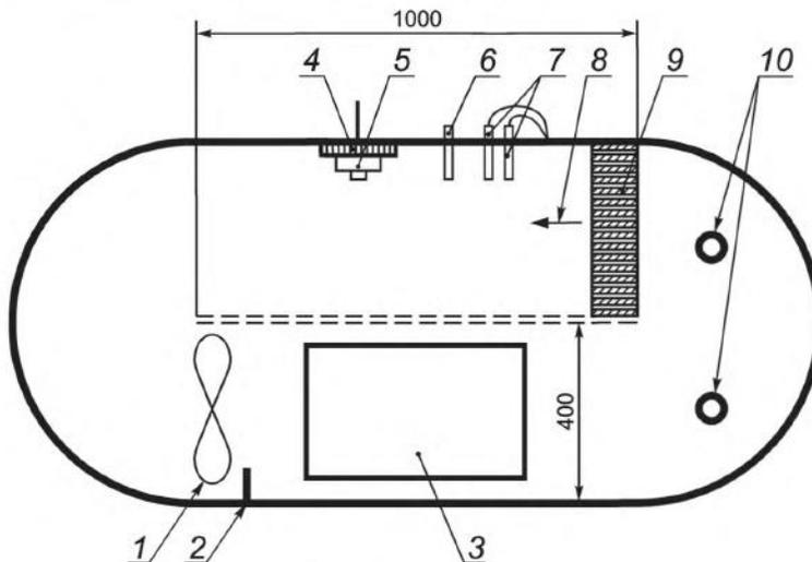
1 — вентилятор с двигателем; 2 — вводный патрубок газа; 3 — техническое окно; 4 — площадка с поворотным устройством для установки испытываемого ИПГ; 5 — испытываемый ИПГ; 6 — газоанализатор; 7 — измерители температуры и скорости потока воздуха; 8 — направление потока воздуха; 9 — линейаризатор; 10 — приточно-вытяжная вентиляция
