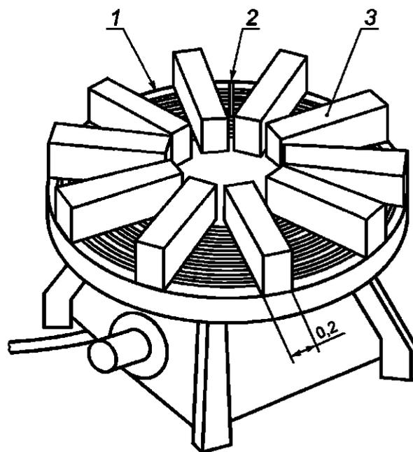
1 — плита; 2 — термопара; 3 — деревянные бруски
