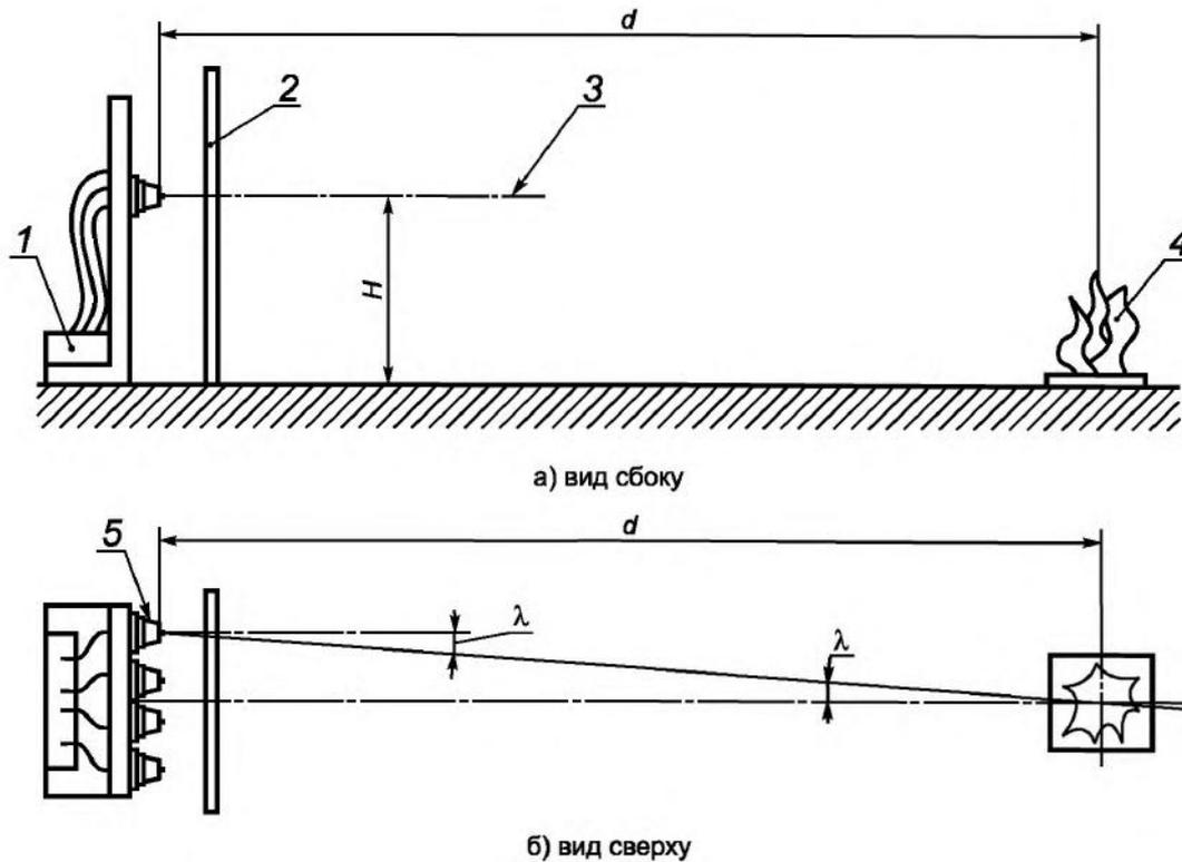
1 — источники питания, приемно-контрольное и измерительное оборудование; 2 — светонепроницаемая перегородка; 3 — оптическая ось ИПП; 4 — тестовый очаг; 5 — испытываемые ИПП;  $d$  — расстояние между ИПП и тестовым очагом;  $H$  — высота размещения испытываемых ИПП над уровнем пола;  $\lambda$  — максимальный угол отклонения оптической оси ИПП от направления на тестовый очаг,  $\lambda = (0^\circ \pm 5^\circ)$ .
