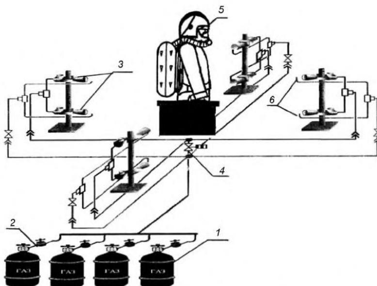
1 — баллоны газовые; 2 — редуктор; 3 — горелки газовые; 4 — клапан электромагнитный;
