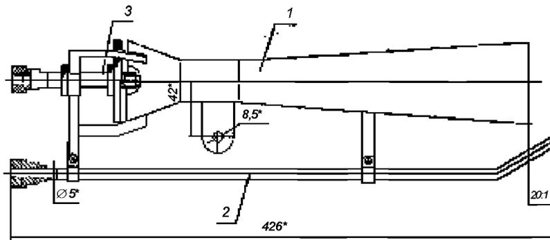
1 — диффузор; 2 — трубка поджига; 3 — сопло
