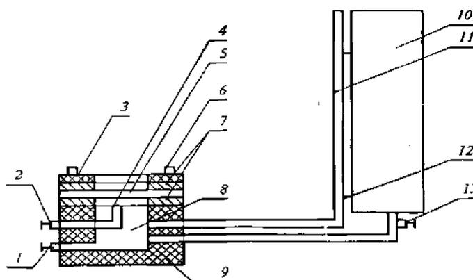
Рисунок 3 — Схема установки для определения водоупорности (водонепроницаемости) материалов
