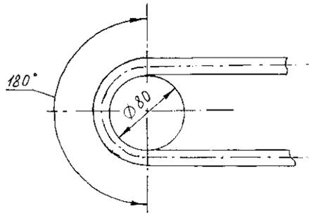
Рисунок 5 — Схема определения работоспособности воздухопроводного шланга
