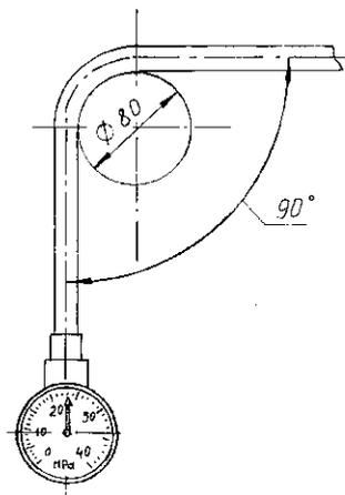
Рисунок 6 — Схема определения работоспособности шланга высокого давления
