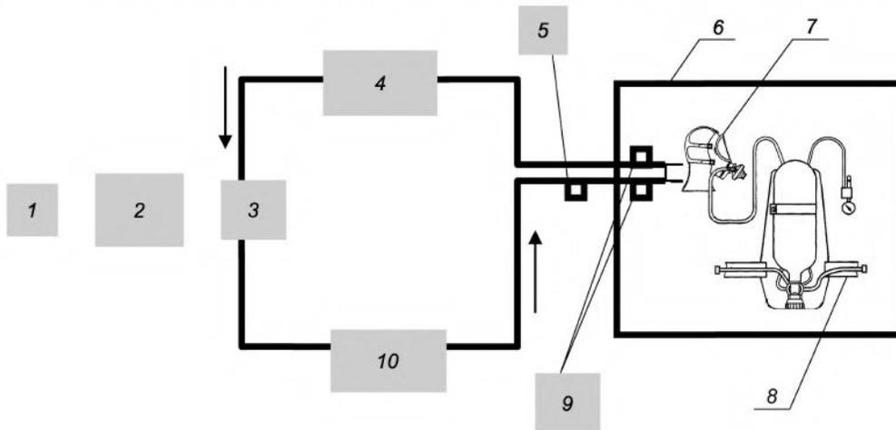
1 — привод насоса «искусственные легкие»; 2 — насос «искусственные легкие»; 3 — клапанная коробка с клапанами вдоха и выдоха; 4 — осушитель; 5 — датчики температуры и влажности; 6 — климатическая камера; 7 — «Шеффилдский» муляж головы человека; 8 — дыхательный аппарат; 9 — датчики сопротивления дыханию; 10 — термостат с увлажнителем
