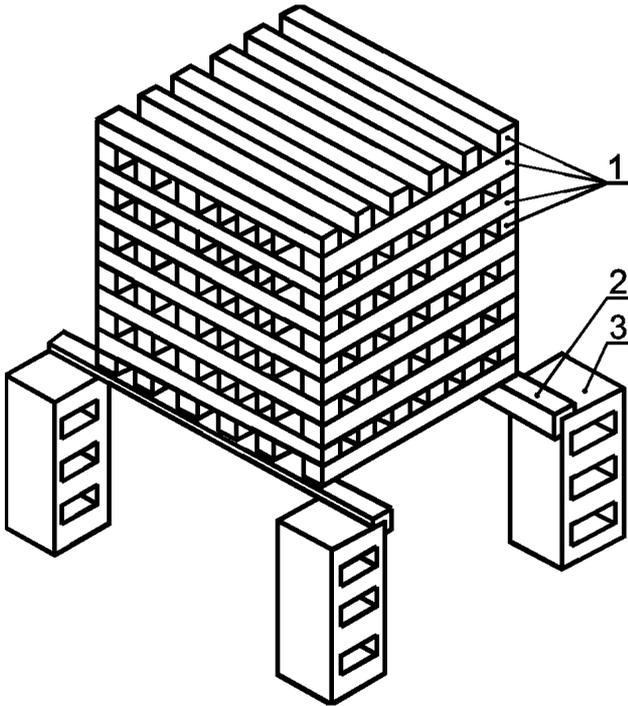
1 — деревянные бруски; 2 — стальной уголок; 3 — бетонный (металлический) блок
