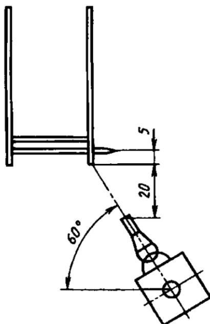
Рисунок 4 — Испытания с кромки
