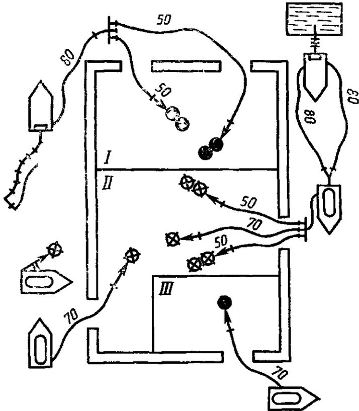
*I* — тушение пеной средней кратности, подаваемой двумя ручными пожарными стволами; *II* — тушение распыленной струей, подаваемой двумя ручными пожарными стволами  $D_y$  50 мм и компактной струей, подаваемой двумя ручными пожарными стволами  $D_y$  70 мм; *III* — тушение пеной низкой кратности, подаваемой ручным пожарным стволом
