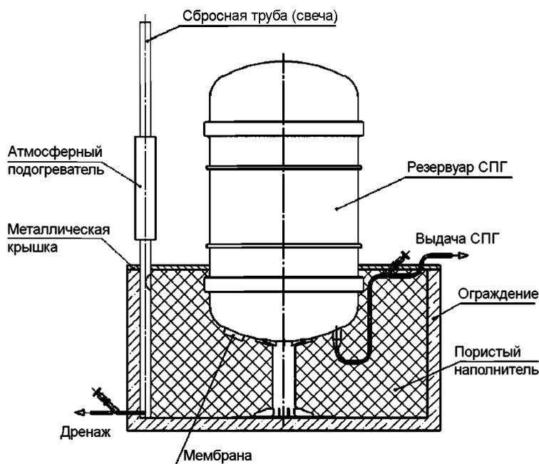
Рисунок А.1 — Принципиальная схема системы предотвращения пожара СПГ,
